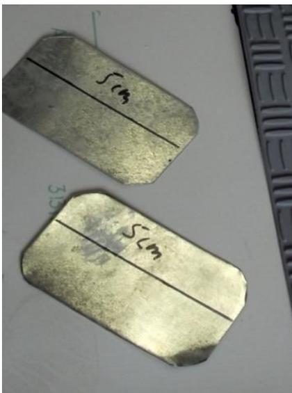
Abb. 03: Vorzubereiten sind 2 Bleche, etwa 20 cm x 12 cm. Z.B. aus verzinktem Blech. Parallel zur Längskante sind im Abstand von 5 cm Anlegemarkierungen aufzuzeichnen.
