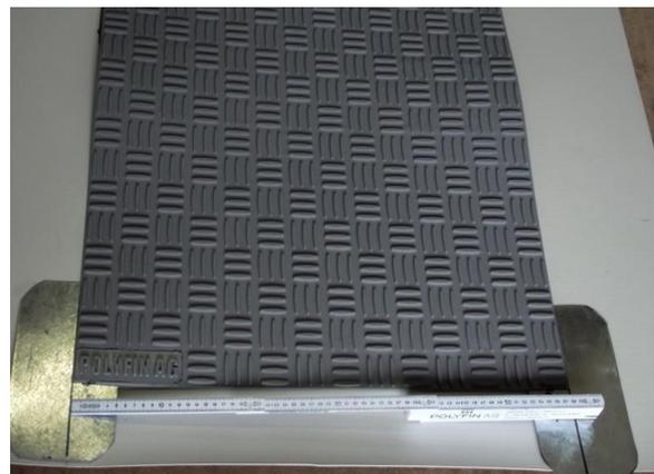
Abb. 04: Positionierung der Bleche zwischen Platte und Trägerbahn.
